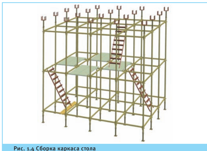
Рис. 1.4 Сборка каркаса стола
