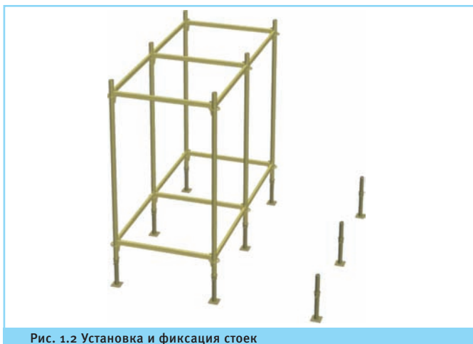
Рис. 1.2 Установка и фиксация стоек
